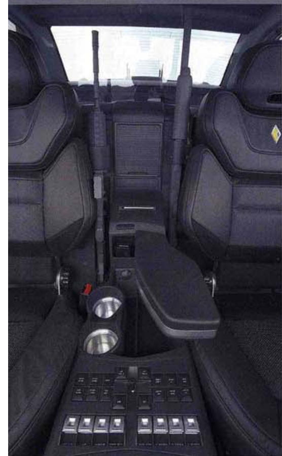
Entre les deux sièges avant, fixés à la cloison séparatrice anti-effraction du compartiment arrière, deux racks permettent le maintien sécurisé de deux armes d'épaule.
