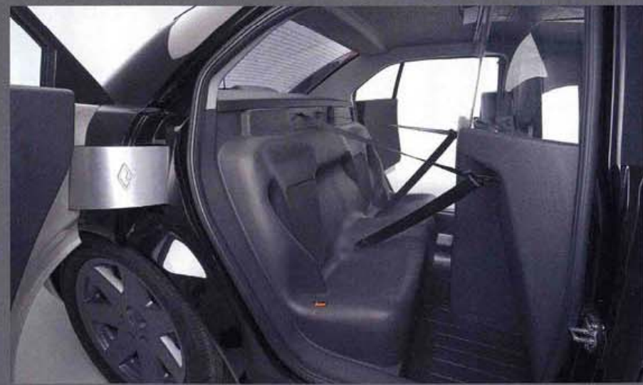
La banquette arrière où prennent place les détenus est réalisée en matériaux facilement lessivables. Elle bénéficie d'un moulage ergonomique qui tient compte de la position assise des suspects menottés dans le dos. Deux ceintures de sécurité y sont intégrées et l'ensemble du compartiment est placé sous surveillance audio et vidéo.
